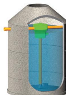
Die Filterelemente und Schmutzfänge sind regelmäßig zu reinigen bzw. zu entleeren.
