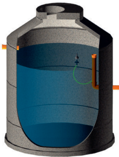
Retentionsschacht mit Retentionsdrossel
