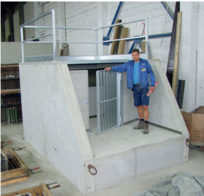
mit schwenkbarem Einlaufgitter
