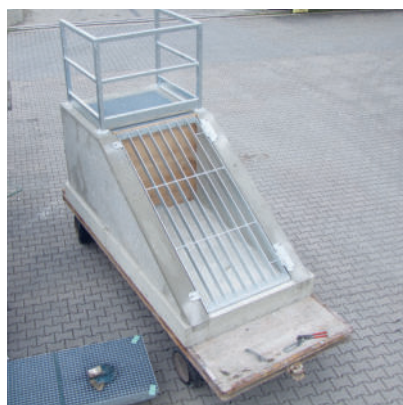
mit Grobgitter und Absturzgeländer
