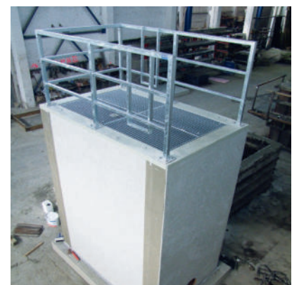
mit verzinktem, 3-seitigem Absturzgeländer
