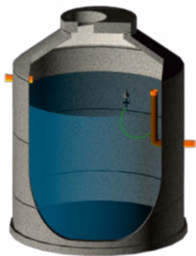
Retentionsschacht mit Retentionsdrossel
