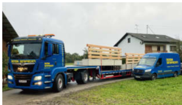
die 2-teilige Ausführung reduziert die Transportbreite
