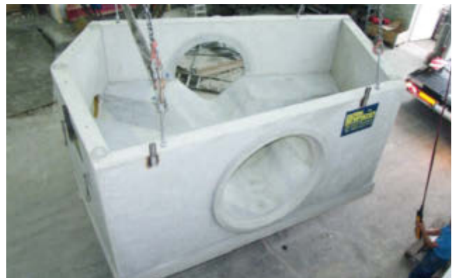
Zulaufbauwerk in Wasserburg
