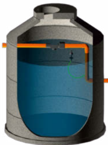
Retentionsschacht mit eingebautem AlphaClean 100 Filter Aufpreise (siehe Seite 59)
